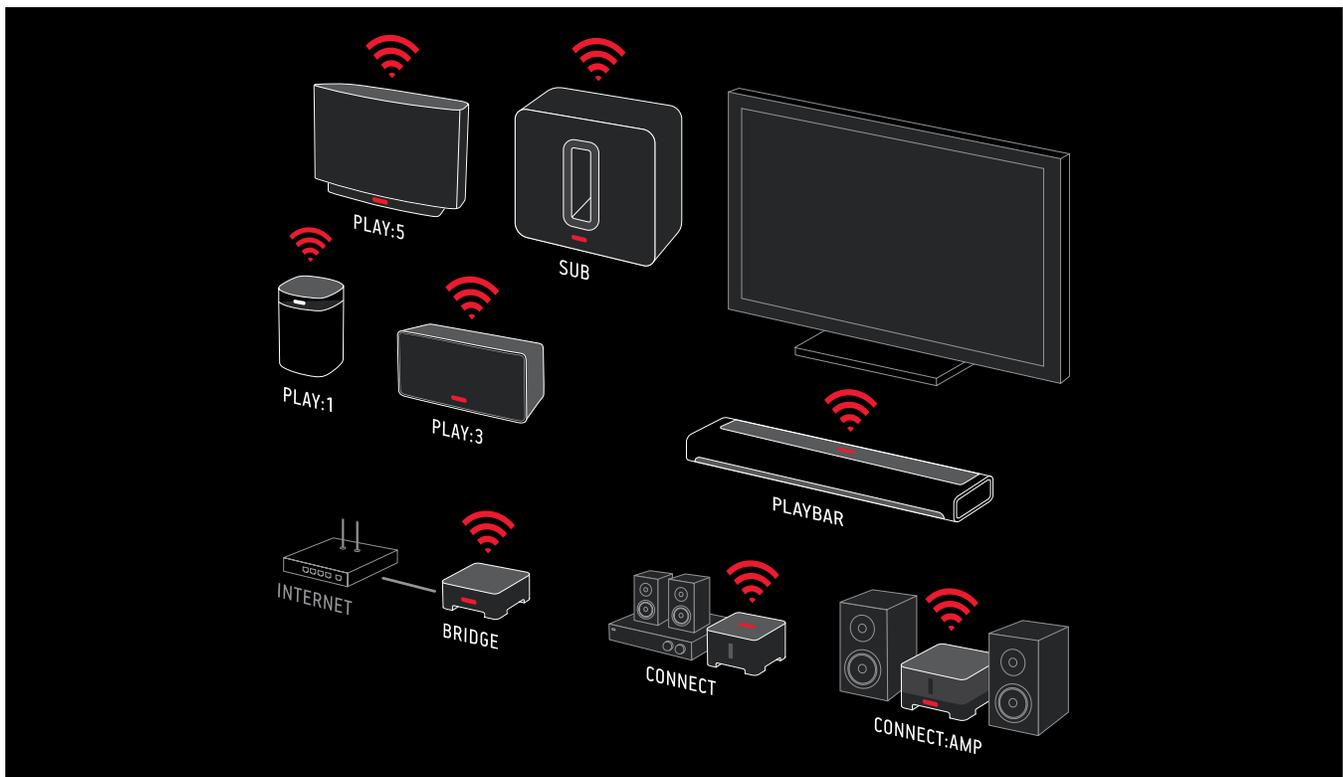
Die BRIDGE startet ein separates Wireless-Netzwerk für mehr Zuverlässigkeit und eine größere Reichweite.
